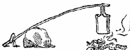
Sobre la barra cruzada se cuelga vuestro caldero mediante un gancho para recipientes. Un simple palo a modo de garfio con una buena muesca hecha en él con el fin de sujetar el mango del caldero.
