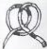
3-Ballestrinque. Para atar una cuerda a un poste
