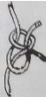
2-Vuelta de escota. Para unir dos extremos de cuerda.
