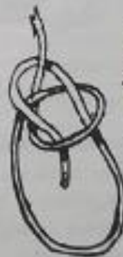
5-As de Guía. Para hacer una lazada que no deslice, como la que se hace a un persona que quieres rescatar del fuego, etc.
